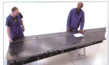
图3 湾流G650热塑性方向舵焊接件
