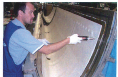
图8 A380飞机J-前缘蒙皮的超声焊接
