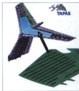
图11 带整体加强肋的TAPAS全尺寸平尾蒙皮
