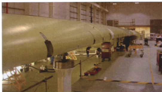
图1 A380机翼固定翼前缘焊接件
